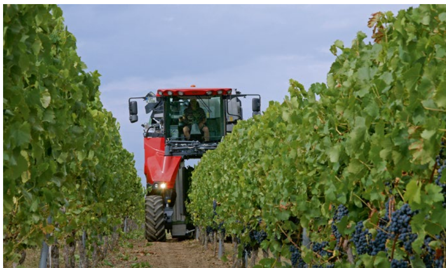
Die selbstfahrenden Traubenvollernter werden besonders durch Weinsäure und Chemikalien stark beansprucht und benötigen daher einen sehr guten Korrosionsschutz.
