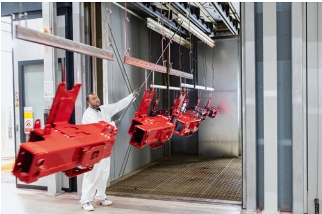
In zwei Kammeröfen werden Primer und Pulverlack bei 190 bis 200 °C für maximal 30 Minuten eingebrannt.
