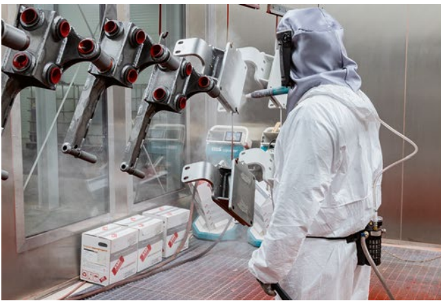
Primer (links) sowie Deck-Pulverlack werden manuell in einer begehbaren Kabine aufgetragen.
